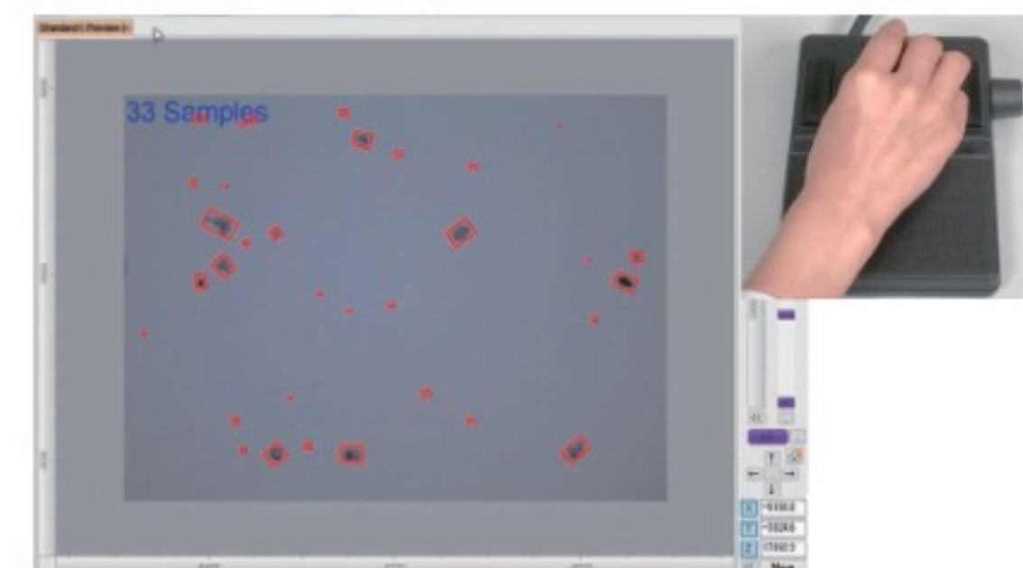
移動載物台，過程即時辨識樣品
