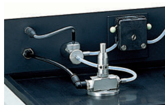
輸液幫浦具感應器，若管路破裂即會自動停止輸送
