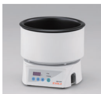
鋁合金外覆鐵氟龍鍋槽 (5.4L) 溫度調節範圍：室溫 +5~180°C
