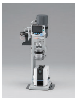
可和溶劑回收裝置 DPE-1150・1250D・E 型組合使用，溶劑回收器可控制真空度外，還可將溶劑蒸氣從真空幫浦的排氣口回收後，利用冷凍槽進行冷卻，並回收於燒瓶中。
