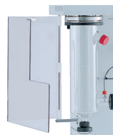
蒸發管具透明保護罩，防止高溫並易於觀察
