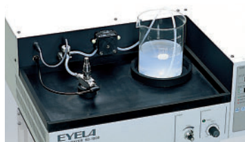
原料部具電磁攪拌裝置，可使溶液混合均勻，避免沈澱
