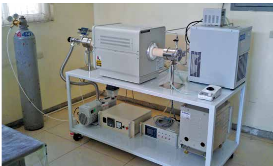
管狀高溫爐含真空氣氛系統及質子流量控制系統架設範例
